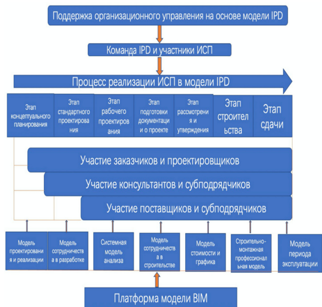
Рис. 2. Схема вовлечения всех подрядчиков в поэтапный процесс строительства с применением BIM-технологий
