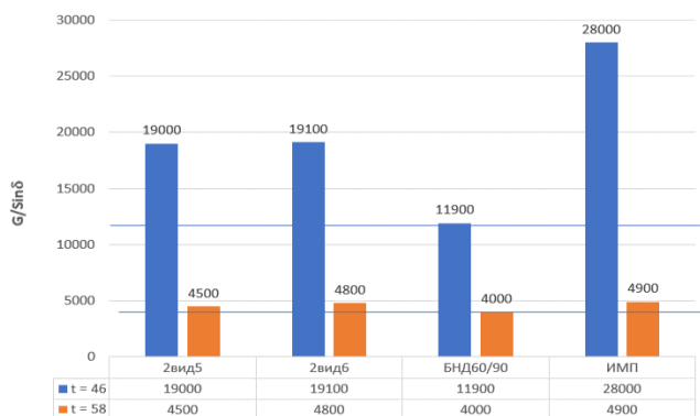
Рисунок 10. – Структурная зависимость G/\text{Sin}\delta от температуры испытания при использовании золобитумных вяжущих модифицированных высококальцевыми золами уноса (10%)
